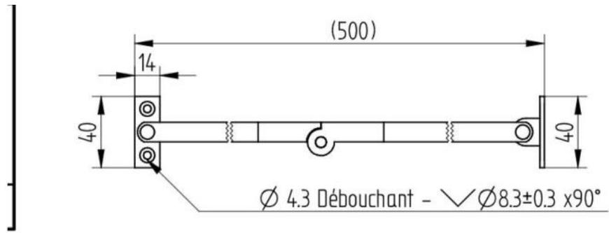
$\varnothing 4.3$  Débouchant -  $\varnothing 8.3 \pm 0.3$  x  $90^\circ$
